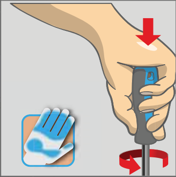
Nagyobb érintkező felület a kézzel = nagyobb nyomaték
