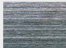
40-es szemcséjű csiszolómozgó hosszú, összefüggő vonalstruktúra, minimális bemélyedések, sima csiszolati kép
