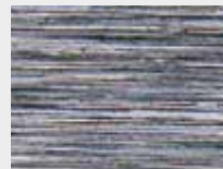
40-es szemcséjű csiszolószalag rövid, markáns vonalstruktúra, érdes felület, kontrasztos csiszolati kép
